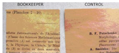
Obr. 7. Změny písma po 24hodinovém kontaktu s vlhkým savým papírem. Vlevo papír odkyselený pomocí metody DAE, kontrolní vzorek napravo.
